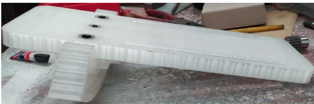
Ilustración 83. Resultado impresión pedal y rueda superior
