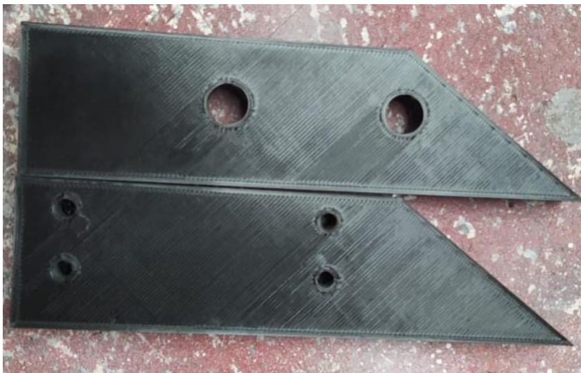
Ilustración 84: resultado impresión soportes medios
