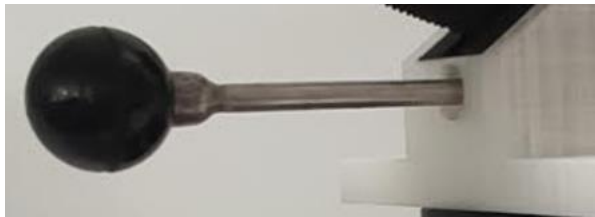
Ilustración 91: Accionamiento manual con bola para giro
