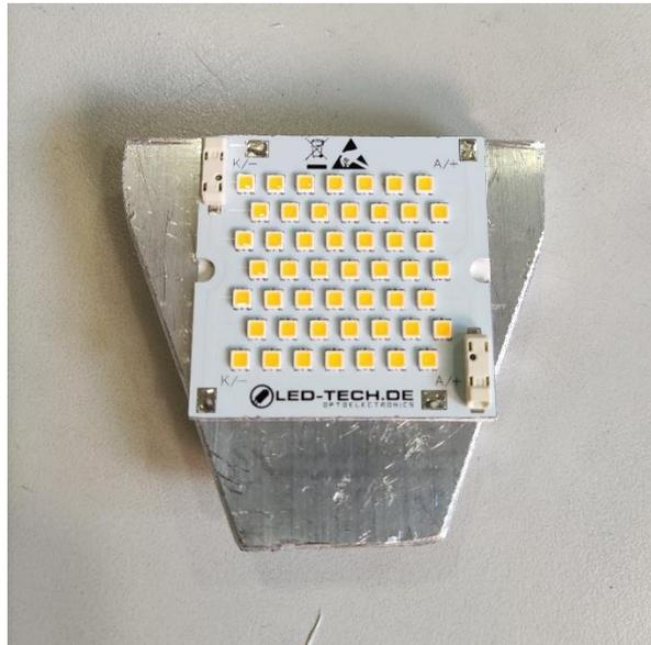
**Figura 39.** Unión placa-disipador. Elaboración propia.
