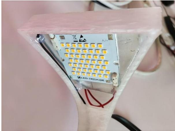
**Figura 28.** Unión mediante pegamento en primer prototipo. Elaboración propia.
