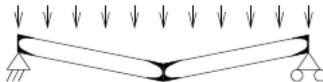
Figura 12: Mecanismo de colapso de una viga biapoyada
