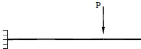
Figura 6: Estructura isostática, barra empotrada y con voladizo
