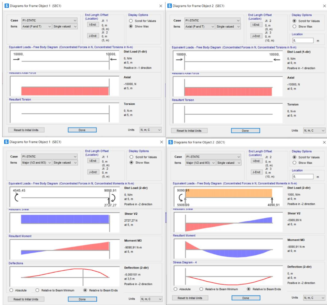
Figura 11. Resultados por cada barra para el cálculo estático en SAP2000. A la izquierda se puede ver los resultados correspondientes a la barra con L=5m, a la derecha los correspondientes a la barra con L=10m.
