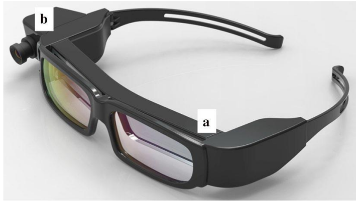
Figura 13. Dispositivo de visualización transparente diseñado en forma de gafa (25)
