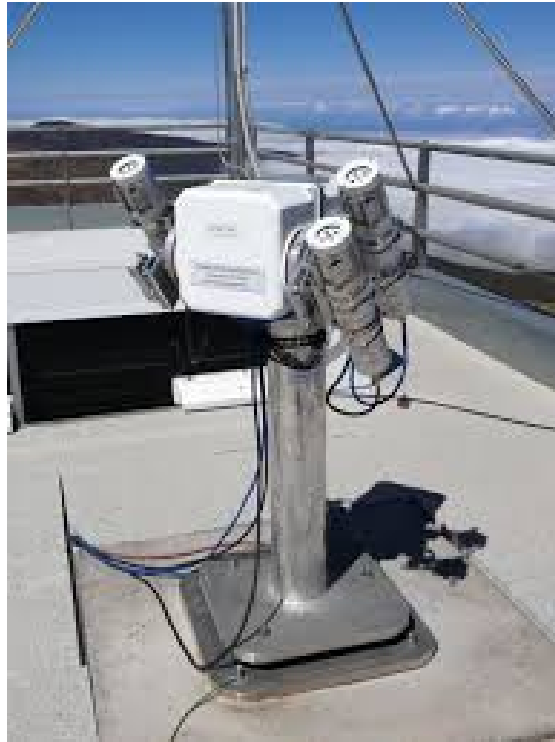
Figura 5.3: Radiómetros PFR montados en un seguidor solar Owel en el Observatorio Atmosférico de Izaña.
