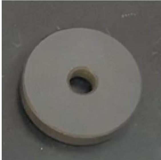
Ilustración 14. Patrón Anillo para partículas magnéticas de los Laboratorios de la Escuela de Ingenierías Industriales de la UVa
