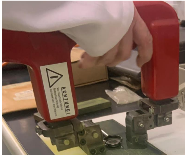
Ilustración 20. Electrodo Portátil para la Magnetización de piezas de los Laboratorios de la Escuela de Ingenierías Industriales de la UVA
