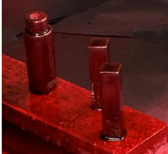
Ilustración 10. Líquido coloreado aplicado a tres piezas metálicas de los Laboratorios de la Escuela de Ingenierías Industriales de la UVA
