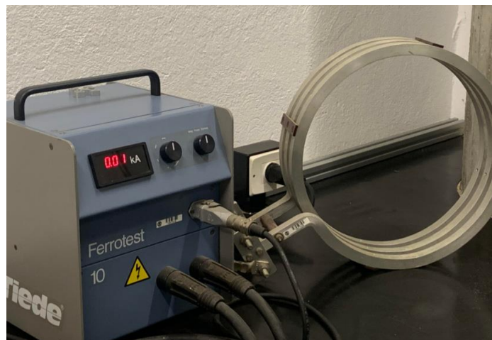
Ilustración 19. Transformador y Bobina para la Magnetización de piezas mediante Magnetización Longitudinal de los Laboratorios de la Escuela de Ingenierías Industriales de la Uva
