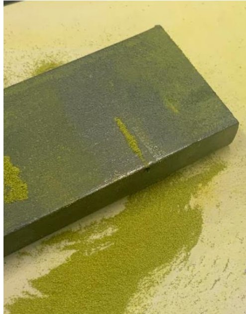
Ilustración 25. Primera muestra de defecto aplicando la Inspección por Partículas Magnéticas de los Laboratorios de la Escuela de Ingenierías Industriales de la UVa
