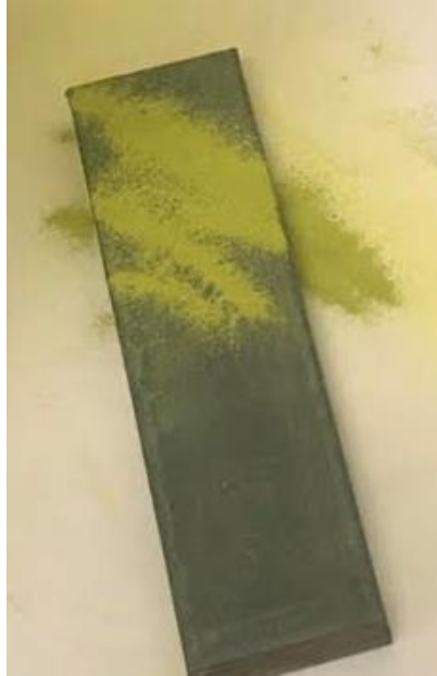
Ilustración 24. Polvo Ferromagnético aplicado a una pieza metálica de los Laboratorios de la Escuela de Ingenierías Industriales de la UVA
