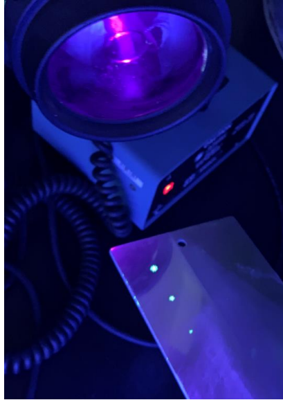
Ilustración 9. Luz Ultravioleta aplicada a un Patrón para revelar sus defectos.
