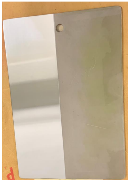
Ilustración 6. Patrón para ensayo de Líquidos penetrantes de los Laboratorios de la Escuela de Ingenierías Industriales de la UVA
