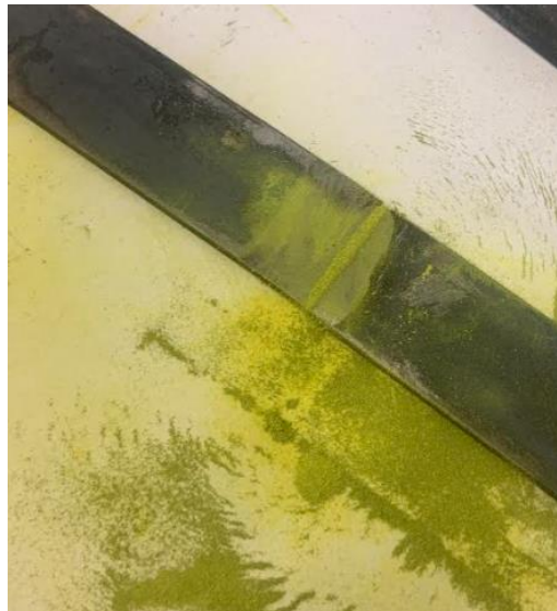
Ilustración 26. Segunda muestra de defecto aplicando la Inspección por Partículas Magnéticas de los Laboratorios de la Escuela de Ingenierías Industriales de la UVa
