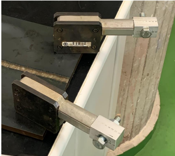
Ilustración 16. Imanes para la magnetización de piezas de los Laboratorios de la Escuela de Ingenierías Industriales de la UVA
