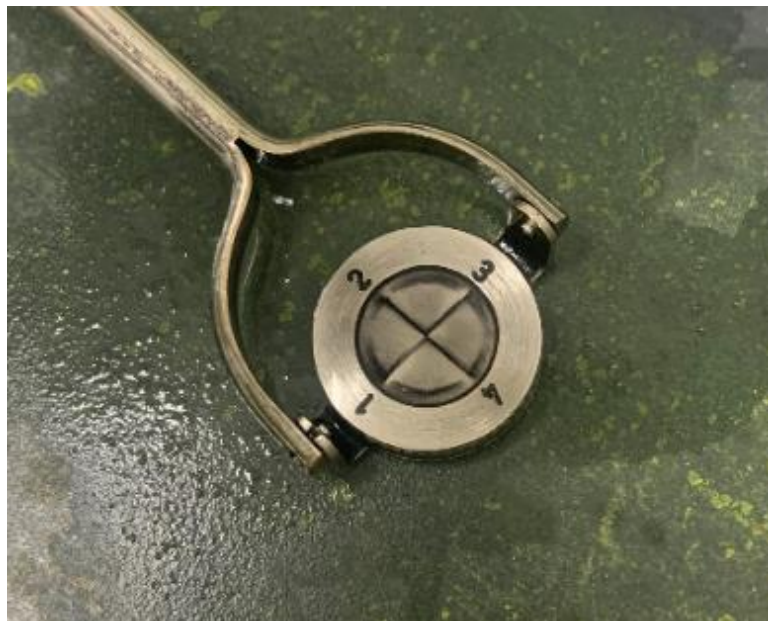
Ilustración 13. Patrón Cruz de Berthold para partículas magnéticas de los Laboratorios de la Escuela de Ingenierías Industriales de la Uva
