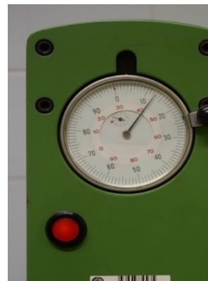
Ilustración 11: Reloj comparador con carga inicial de 10Kg
