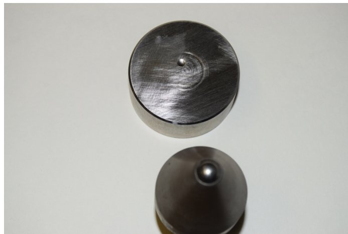
Ilustración 3. Huella penetrador Brinell
