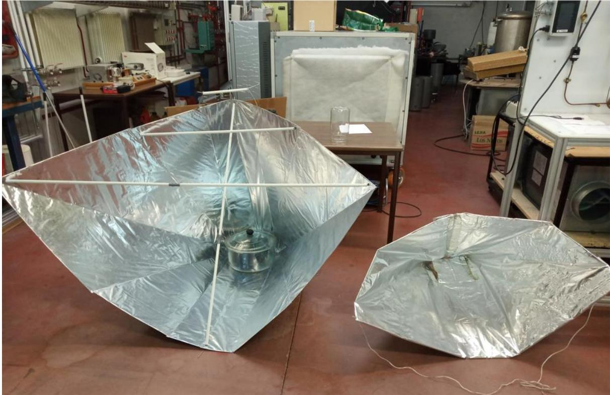
*Figura 38: Cocinas solares tipo Funnel que se caracterizan en el presente proyecto.*
