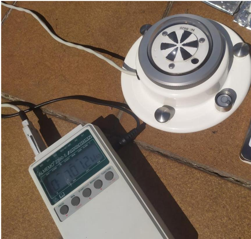
Figura 52: Piranómetro y “datalogger” usado para medir la potencia solar.
