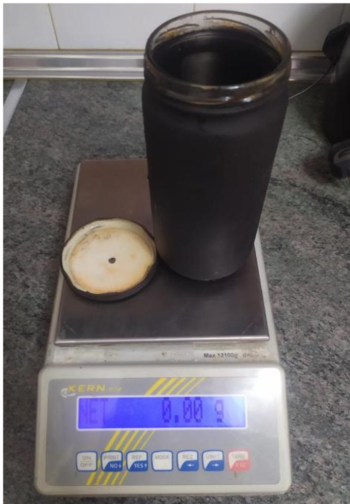
Figura 53: Puesta a “0” de la báscula con el recipiente de cocción.
