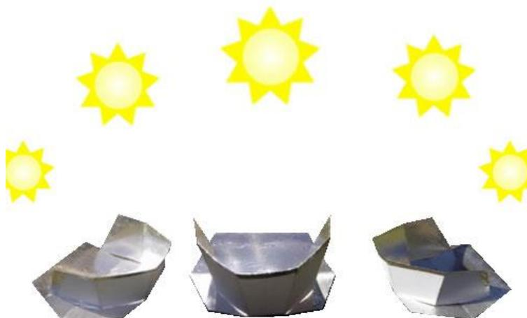
*Figura 47: Correcta orientación de la cocina solar respecto del sol.*
