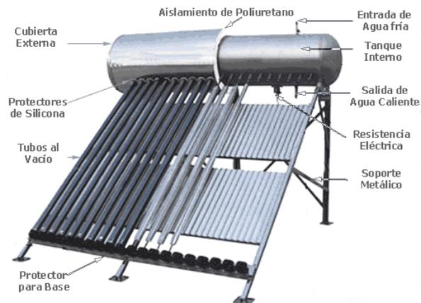
Figura 42: Colector solar de tubos de vacío con cambio de fase.
