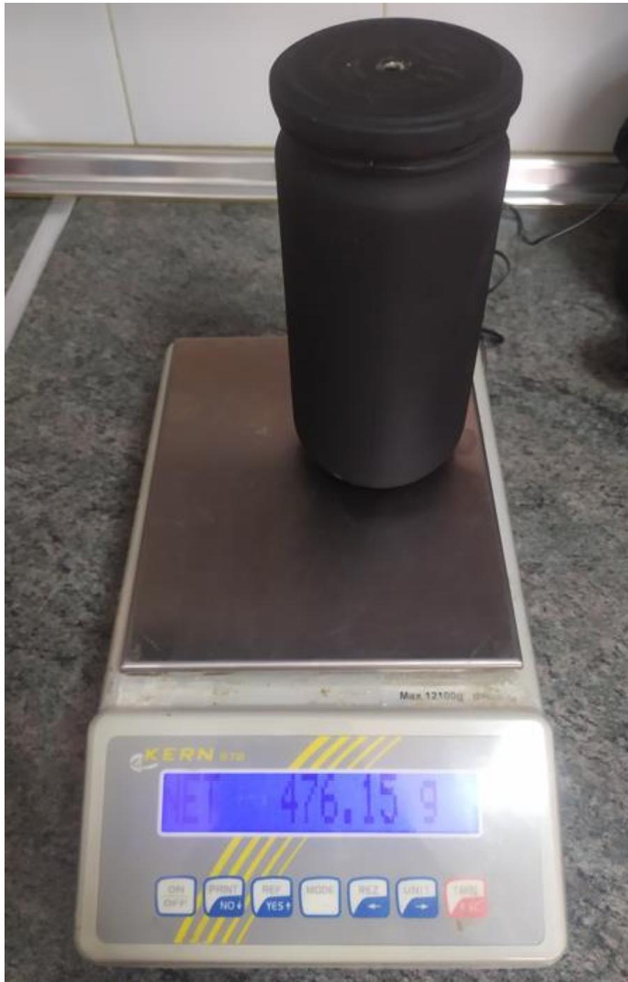
Figura 54: Medida del recipiente de cocción lleno de agua, sin tener en cuenta la masa del recipiente.
