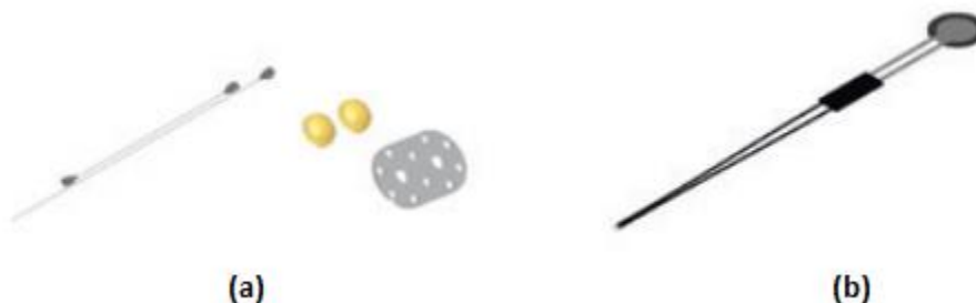
Figura 9. Electrodo de perfil bajo (a) y Sensor de fuerza resistivo (b). [15]
