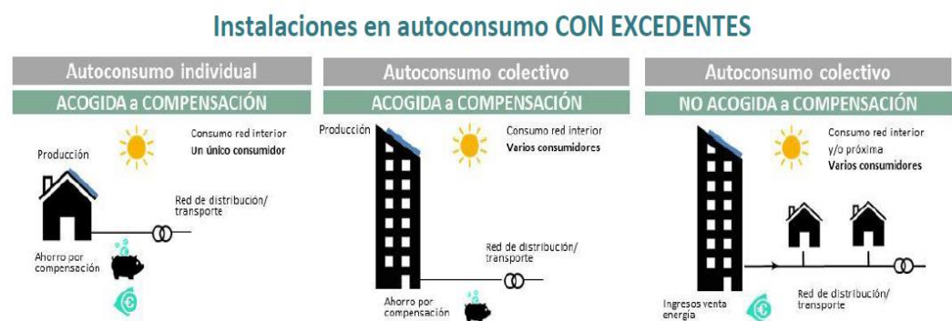
Figura 14. Esquema de instalaciones de autoconsumo con excedentes. (Fuente. Guía IDAE de autoconsumo).
