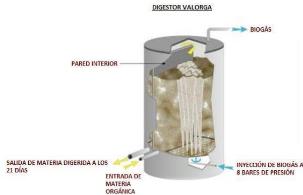
Figura 3: Digestor Valorga de digestión seca
