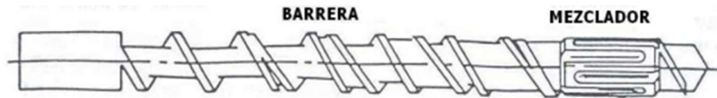
Figura 12: Tornillo de dos etapas con Mezclador. [7]
