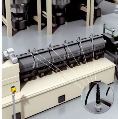
Figura 19: Conexión Sensores de presión Sick Sensor Intelligence. [Suministrado por Sick Sensor Intelligence].
