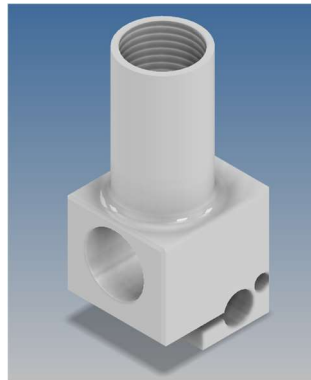
Figura 50: Bloque de Calentamiento con sensor. Elaboración propia.
