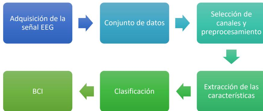
*Ilustración 39. Funcionamiento básico de una interfaz cerebro-computadora.*
