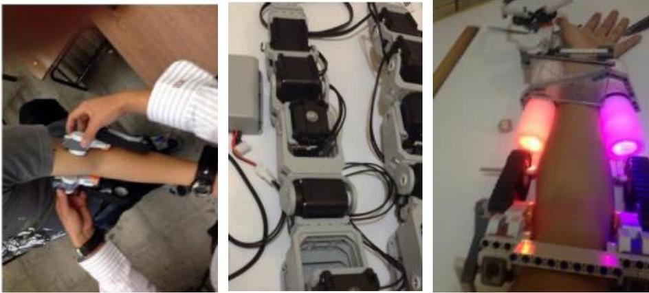
*Ilustración 36. Exoesqueleto fabricado con Servomotor LEGO.*
