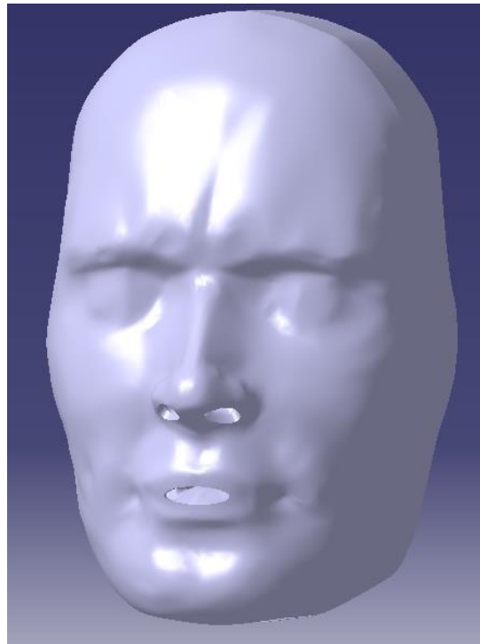
Figura 92. Agujeros elípticos realizados en la nariz y la boca del sólido generado a partir de la nube de puntos que definen la careta.
