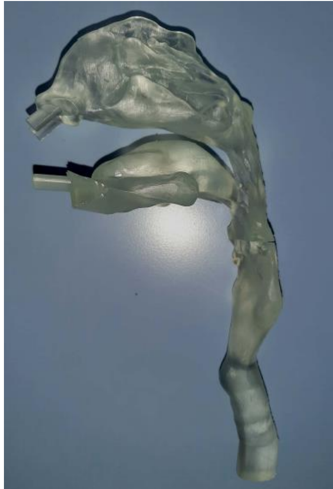
Figura 95. Fotografía del tracto respiratorio completo impreso en 3D.
