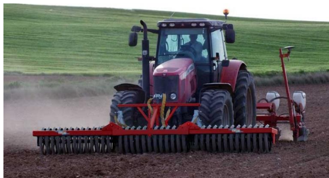
Ilustración 30. Tractor con preparador delantero delante y sembradora detrás.
