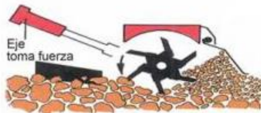
Ilustración 21. Funcionamiento del rotocultivador sobre el suelo.
