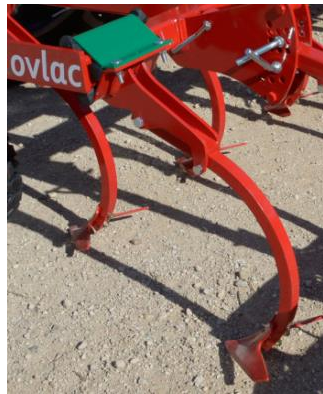
Ilustración 40. Brazo de cultivador con sistema de elastómeros.
