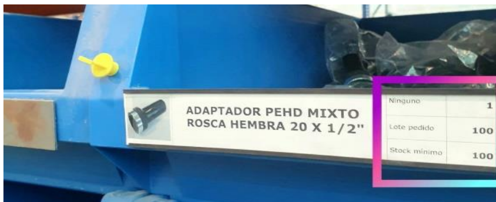
Figura 3.10. Lote mínimo y stock mínimo de una pieza. (Fuente: Fábrica de Indemat)
