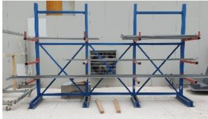
Figura 4.25. Estanterías cantilever del almacén en Indemat.
