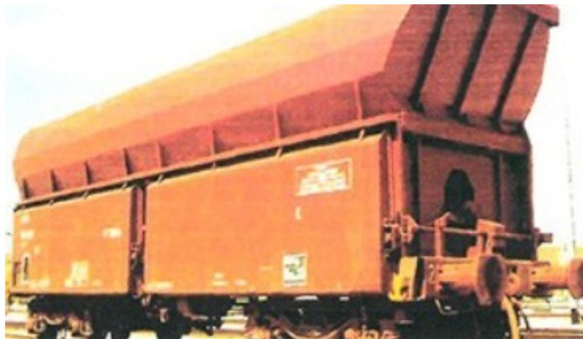
Figura 3.5. Tolva granelera descubierta. Fuente: RENFE
