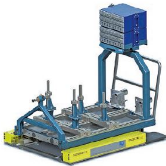
Figura 22: Cuna para instalación de un motor en el banco.
