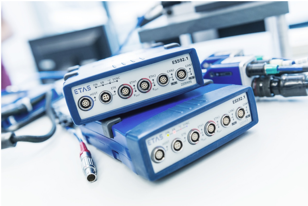
Figura 41: Equipos ETAS 592.1 utilizados para la adquisición de datos del control motor en los trabajos de puesta a punto de vehículos [11].
