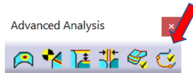
Figura 2.195 Comando Curve Check.
