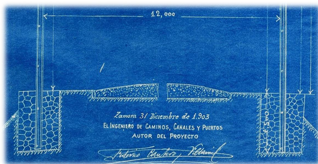
(5)Aspecto que tenía el cruce de la carretera en 1903; para el año 1905 se mantiene la distancia del vano, y se han modificado ya los postes. Ver anexos. AGA Obras Públicas 00796
