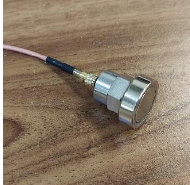
Figura 5.6: Acople del Acelerómetro a la estructura
