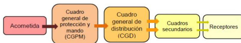
Ilustración 1. Red de instalación eléctrica
