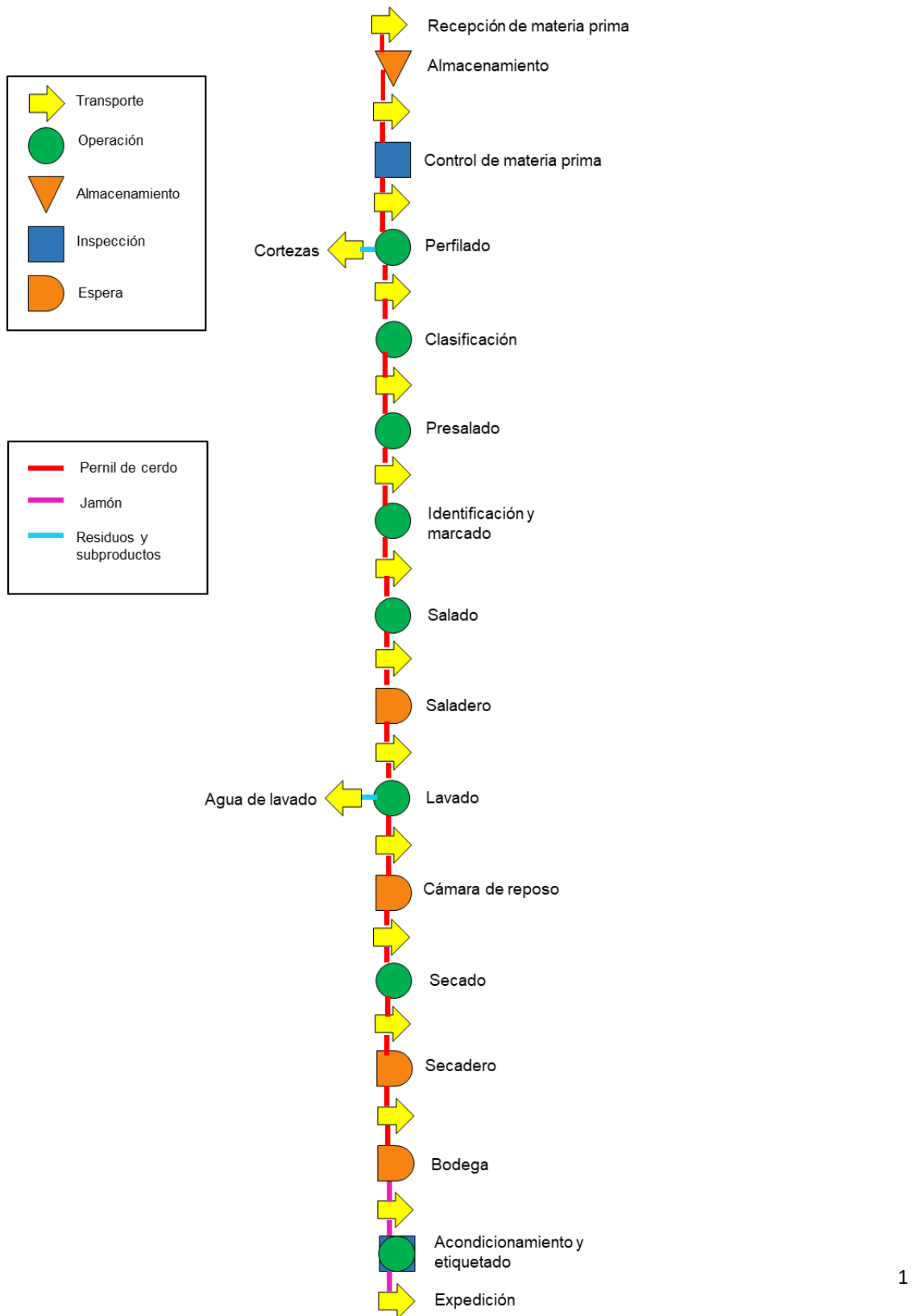
Ilustración 1. Diagrama de recorrido sencillo del proceso de elaboración del jamón curado.
