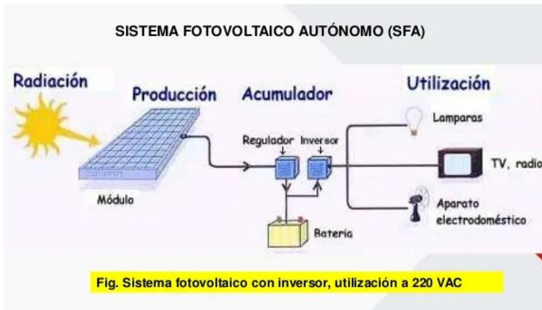
Ilustración 1: Sistema Fotovoltaico. Fuente: <https://es.slideshare.net/avalin/sistemas-de-energa-fotovoltaica>
