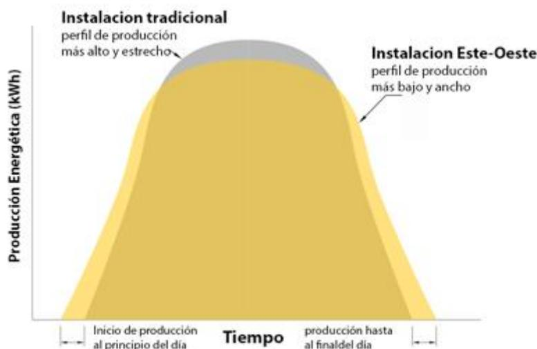
Ilustración 25: Producción Orientación Sur vs Orientación Este-Oeste [57]
