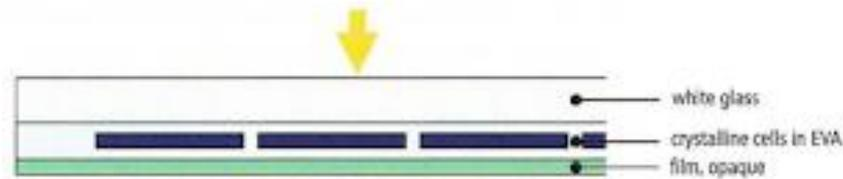
Ilustración 2: Capas Paneles Solares. Fuente: <https://www.diariorenovables.com/2017/06/tipos-de-encapsulamiento-en-celulas.html>
