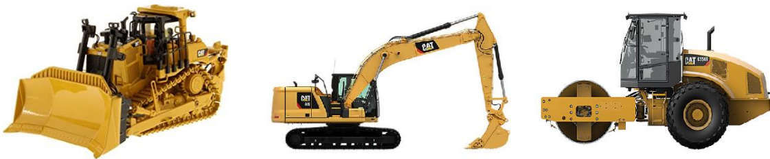
Figura 3.6.: Maquinaria que se utiliza para la ejecución del relleno. 1: Bull-dozer 2: Retroexcavadora. 3: Rodillo compactador
