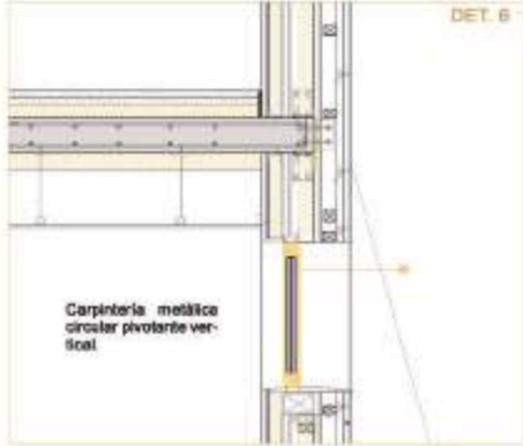
Carpintería metálica circular pivotante vertical
