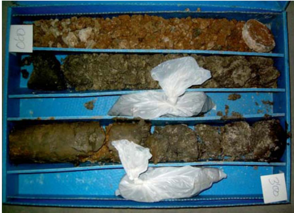
Figura I.A7.19. Material extraído del sondeo, tramo 1.
