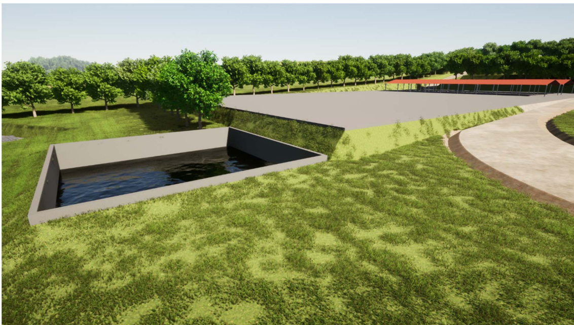
Figura I.A1.3. Simulación virtual de balsa de efluentes existente, junto a la solera en la que se desarrolla el compostaje de los residuos sólidos y las tejavanas de almacenamiento del compost terminado. Fuente: elaboración propia.
