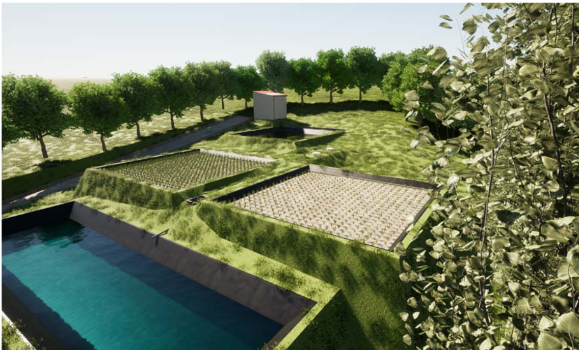
Figura I.M.10. Simulación virtual de la depuradora. En la zona superior se observa la edificación, seguida de a balsa de alivio y las dos celdas del humedal. Entre ambas celdas se ubica la arqueta que realiza la recogida de aguas depuradas y las vierte a la balsa de la zona inferior. Fuente: elaboración propia.
