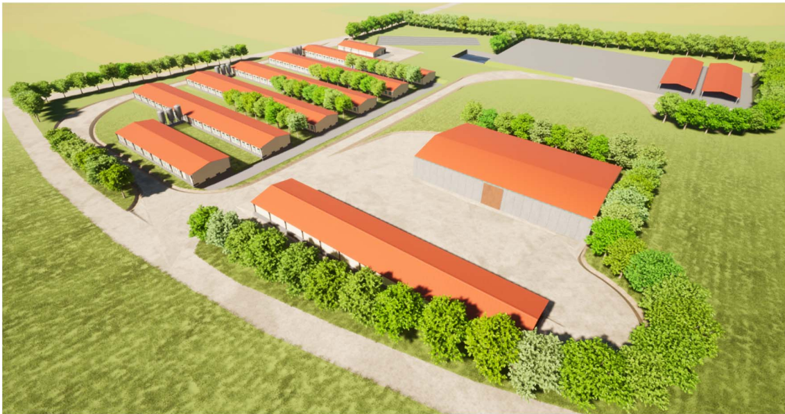
Figura I.A1.2. Simulación virtual de la explotación cunícola y el conjunto parcelario en su situación actual. El grupo de 7 naves en la zona superior izquierda de la figura corresponden, de izquierda a derecha, a la nave de reposición y recría, 5 naves de producción y nave de servicios y almacén de consumibles. En la zona superior se encuentra la instalación solar fotovoltaica, la balsa de efluentes, la solera de compostaje y las tejavanas para almacenar el compost terminado. En la zona central se encuentra la nave de almacenamiento de grano y forraje, y en la zona inferior la nave de almacenamiento de maquinaria y productos fitosanitarios. Fuente: elaboración propia.
