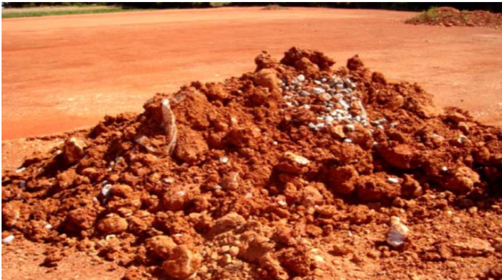
Figura I.A7.13. Material extraído de la calicata 1.
