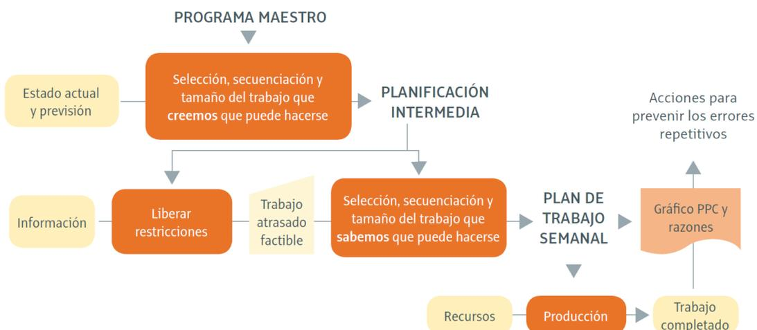
**Figura 12:** Esquema de Planificación del Proyecto usando LPS.
