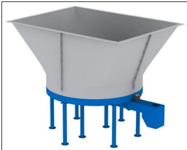
Imagen 28. Tolva de alimentación para el refinador y su ficha técnica correspondiente. (Fuente: Ecofricalia Sostenible S.L.).
