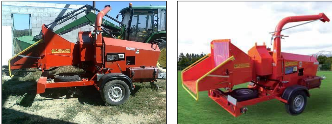
Imagen 26. Astilladora a remolque marca Caravaggi modelo CIPPO25. (Fuente: Interempresas.net).
