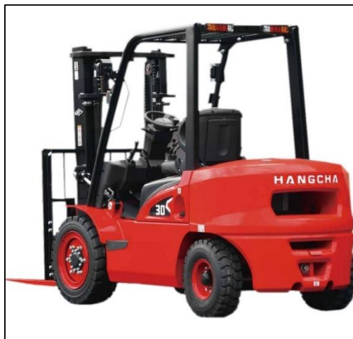
Imagen 39. Carretilla elevadora HC SERIE XR (1,8-3,8T). (Fuente: Alce carretillas elevadoras).
