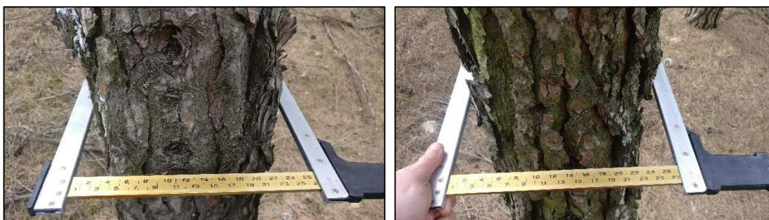
Imagen 14. Toma de medidas de los diámetros normales de pinus halepensis en una parcela de muestreo del M.U.P. "Laderas de Ampudia". (Fuente: elaboración propia).
