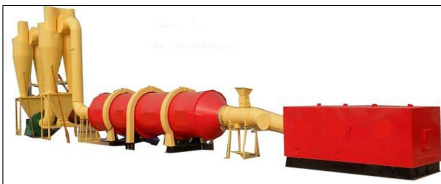
Imagen 33. Secadero tipo tromel con caldera de polibiomasa conectados. (Fuente: Bruna García.M, 2019).
