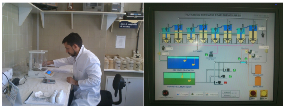
Foto 7. Pesado de los filtros en la determinación de los sólidos suspendidos. Foto 8. Panel de control del proceso de filtrado en el tratamiento terciario.
