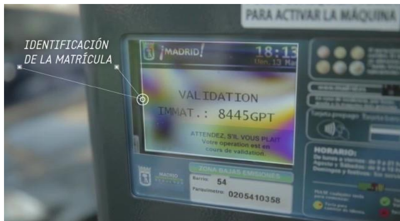
Imagen 11 - Pantalla de parquímetro. Tarificación del estacionamiento Fuente: Empresa gestora
