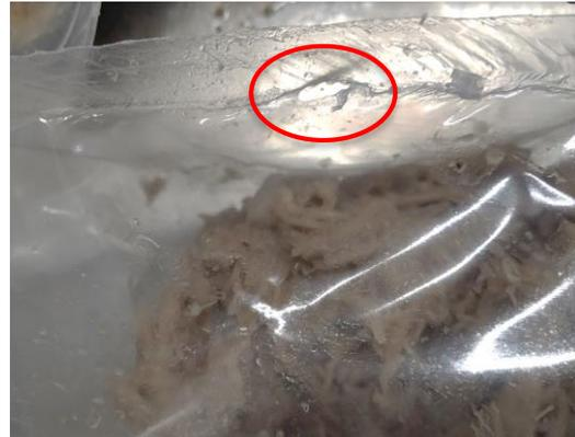
*Fig 6. Quemadura en la costura durante el envasado* *Fig 7. Mini rotura en la costura del envase*
