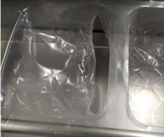
*Fig 4. Rotura del film durante el envasado*
