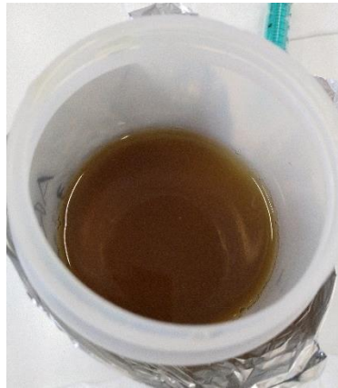
Figura 25. Precipitado verde tras ajuste de pH a 8.
