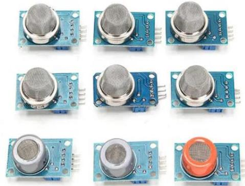
Figura 10: Gama de sensores de gases MQ comerciales.
