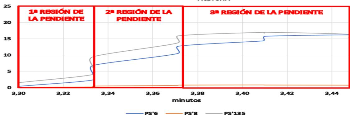
Figura 17: Ejemplo gráfico de la selección de zonas características de la señal, utilizando la pendiente de la variable  $S'$  para identificar las zonas características. Gráfica de la pendiente  $S'$  del VOC acetona”.
