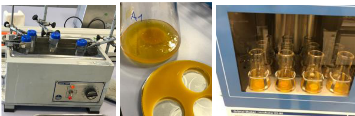
Figura 8. Fusión de cera para el dopaje, formación de discos de cera y posterior puesta en contacto con la miel para el estudio de la migración
