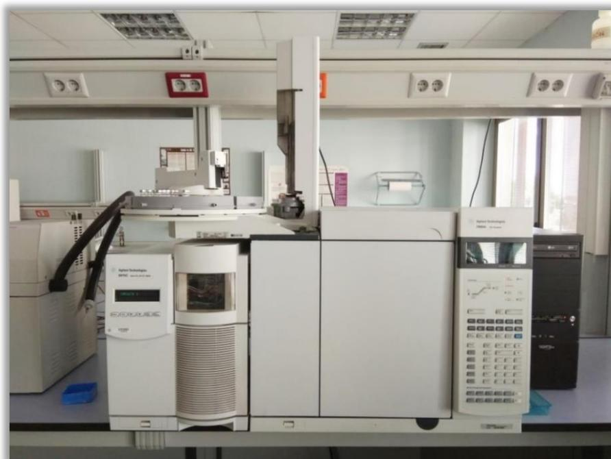
*Ilustración 2: Cromatógrafo de gases Agilent Technologies series 7890 A acoplado a detector de espectrometría de masas Agilent Technologies 5975 C*
