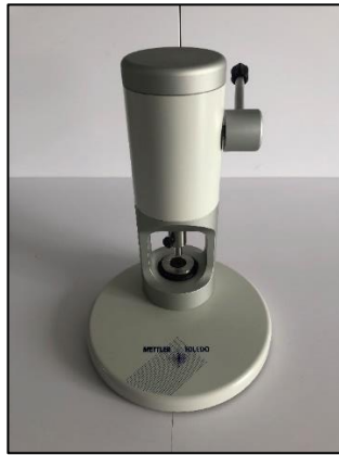
Figura 11. Fotografía del cierracrisoles
