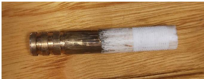
*Figura 19. Barra de muestra compactada de la NAC.*
