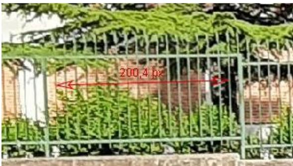
*Figura 3-37. Se analizan los píxeles que hay en 17 intervalos entre barrotes de la parte sin telescopio de la fotografía anterior.*
