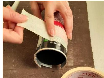
Figura 3-29. Después de pegar la cartulina, se sujeta con cinta de carrocer.
