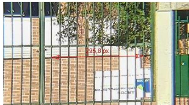
*Figura 3-38. Se analizan los píxeles que hay en 11 intervalos entre barrotes de la parte a través del telescopio de la fotografía anterior.*
