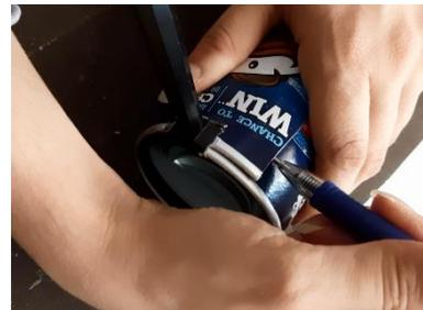
Figura 3-24. Se dibuja una marca con el cilindro ajustado a la lupa.
