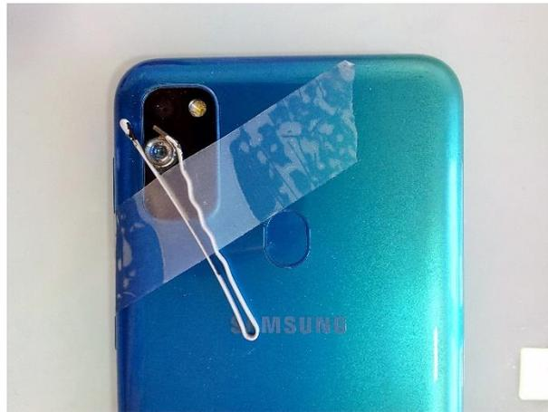
Figura 3-42. Lente colocada en la cámara del móvil funcionando de microscopio.
