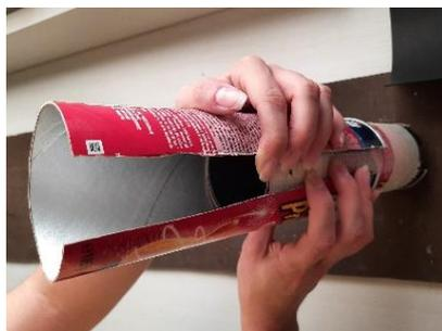
Figura 3-30. Para el cilindro exterior, se toman las medidas directamente sobre el cilindro interior.
