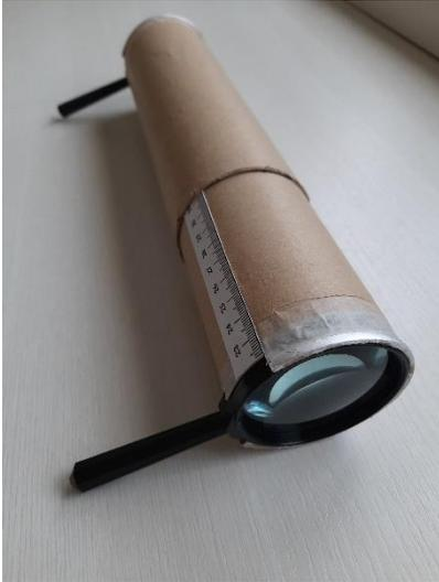
Figura 3-33. Se colocan las lupas en cada extremo de los tubos.
