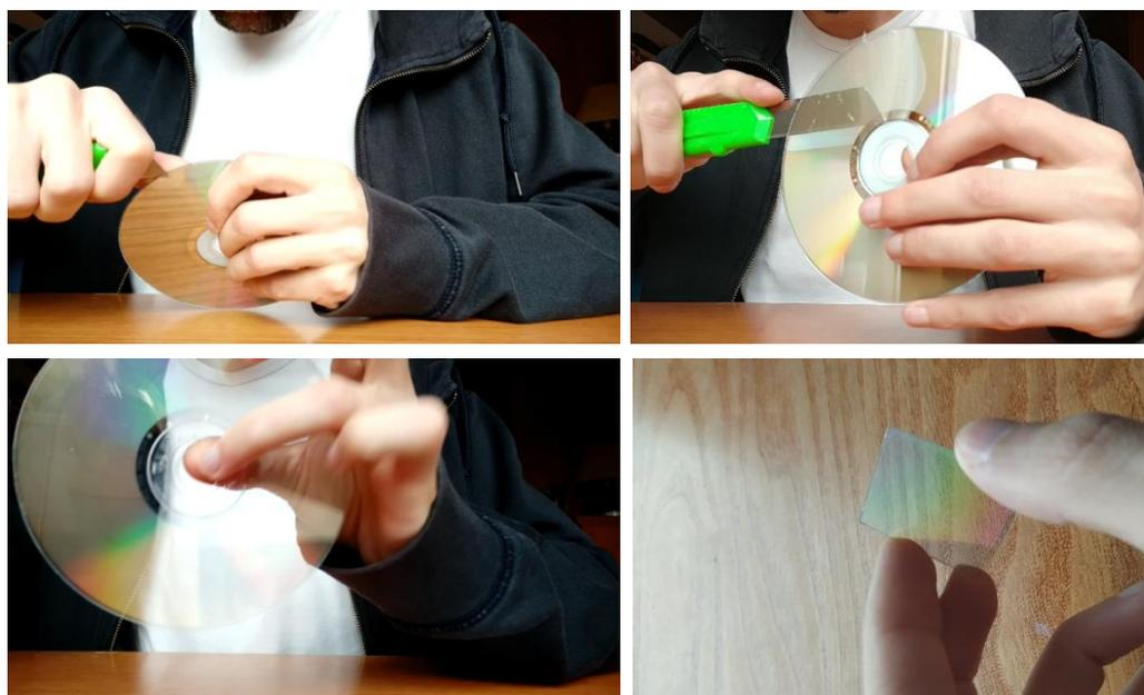
*Figura 6. Obtención de la red de difracción a partir de un DVD.*
