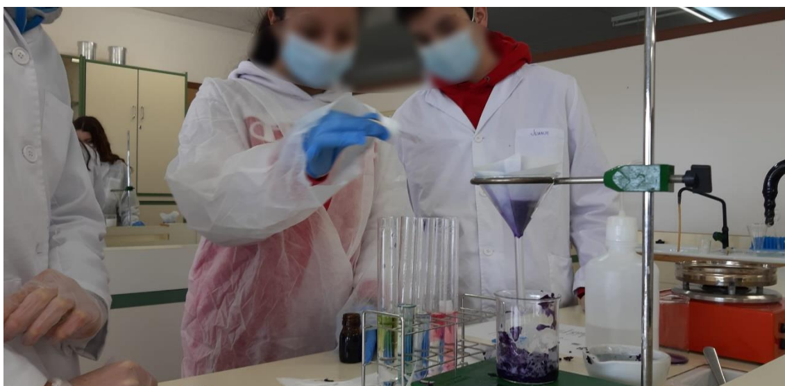
Figura 5. Grupo de tres integrantes (uno de 2º de ESO y dos de 1º de Bachillerato). La alumna de 2º de ESO está comprobando el pH de las disoluciones presentes en los tubos de ensayo utilizando como indicador el extraído de la lombarda.
