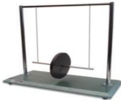
Figura 22. Montaje del soporte con el disco de Maxwell.
