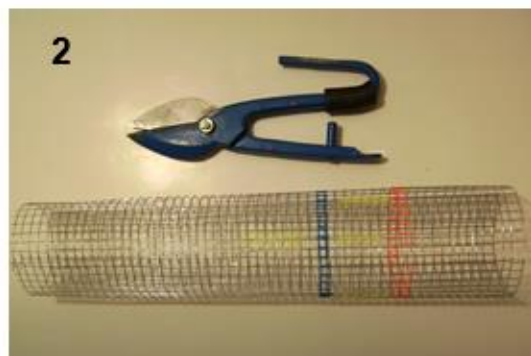
Figura 2. Doblar con forma de cilindro uniendo las varillas de los extremos con ayuda de un alicate.
