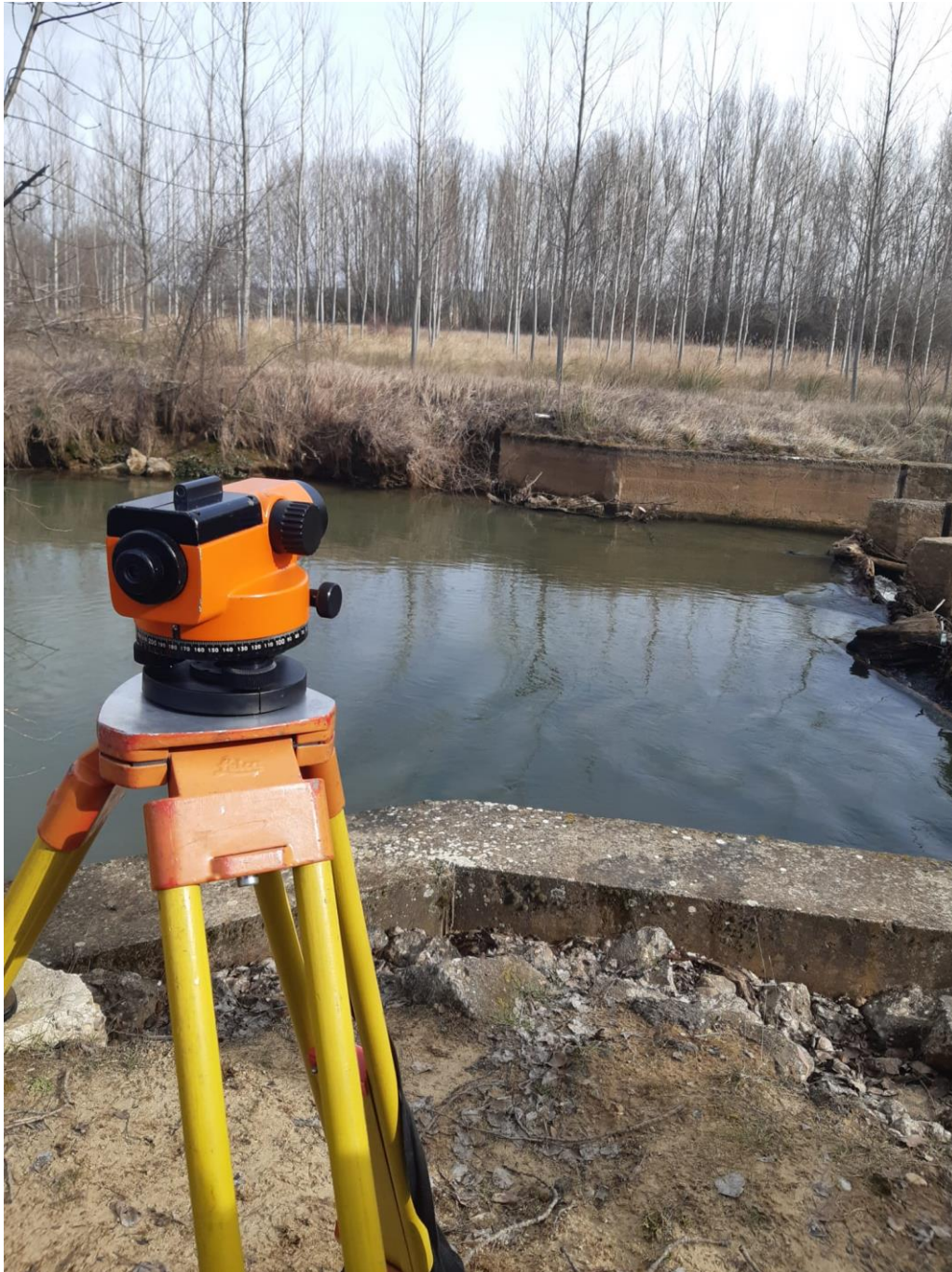
Figura 8. Estacionamiento del nivel en la margen derecha mientras se realiza el levantamiento topográfico. Fuente: propia.
