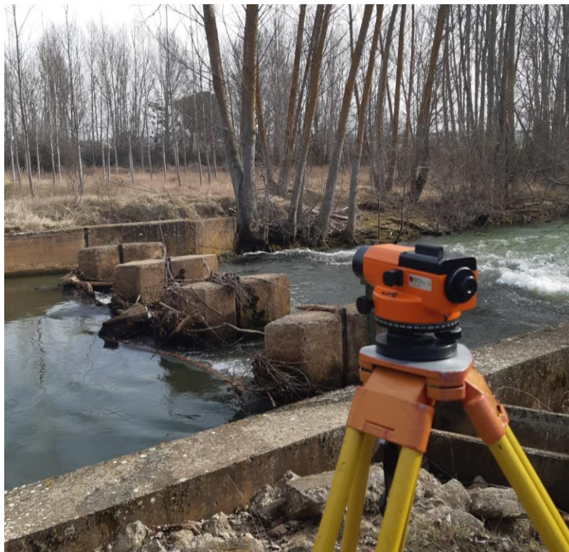
Figura 2. Estacionamiento en campo del nivel topográfico. Fuente: Propia.
