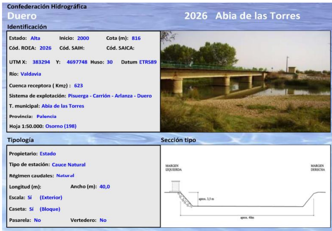
Figura 3. Cuadro técnico y de especificaciones estructurales para la estación de aforos Nº 2026 RÍO ABANADES O VALDAVIA EN ABIA DE LAS TORRES. Fuente: CEDEX
