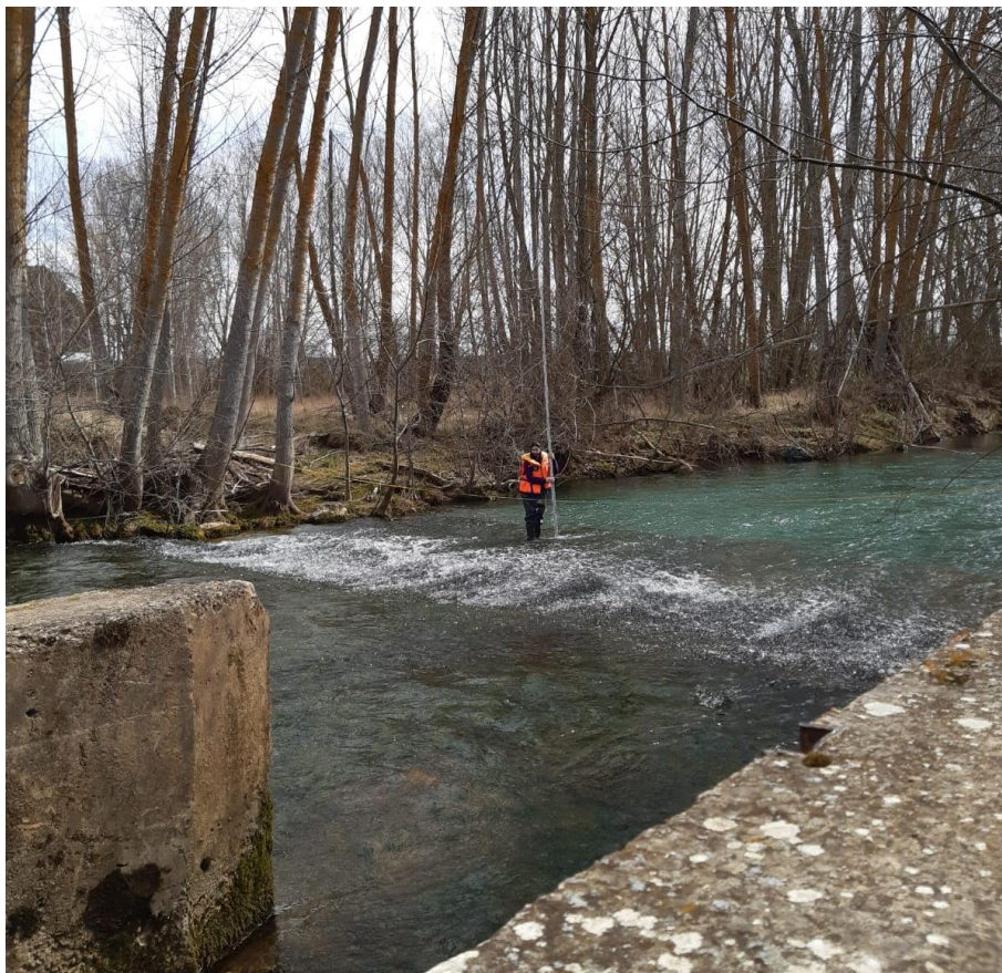
Figura 7. Toma de cotas con el nivel y mira de aluminio en la sección transversal aguas abajo de la presa. Fuente: Propia.
