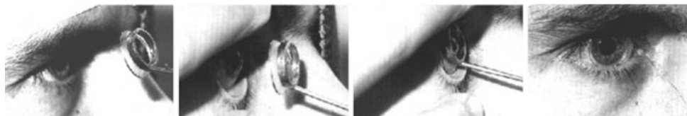
Figura 2.8: Ejemplo de inserción de una lente de contacto para medición de movimiento ocular. [1]
