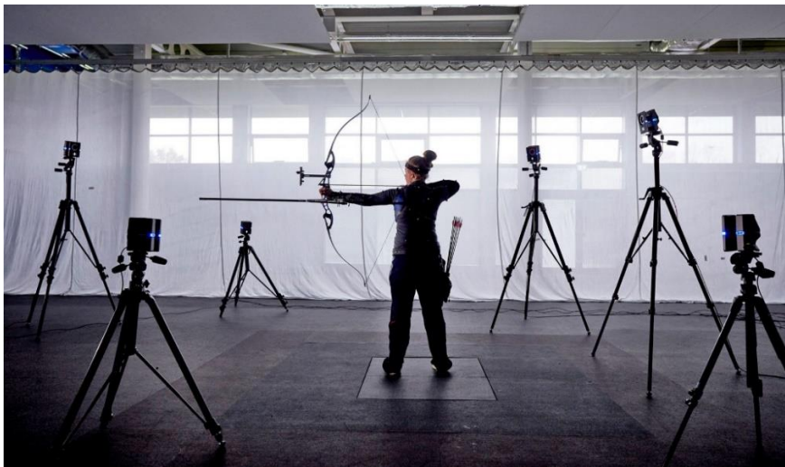
Figura 7. Captura de movimiento vía sensores optoelectrónicos
