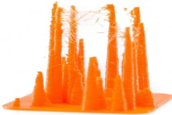
Figura 119: pieza con mal ajuste de retracción
