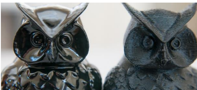
Figura 25: Ejemplo de material posprocesado versus no posprocesado
