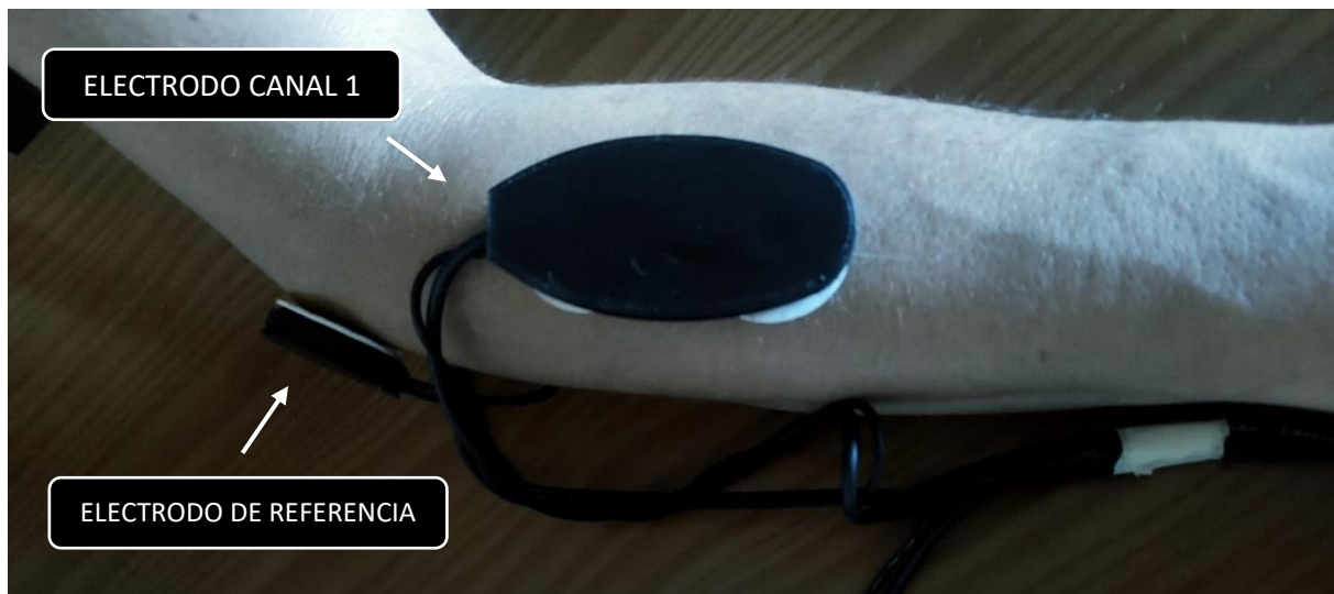
Figura 102: Disposición de los electrodos en el flexor profundo de los dedos
