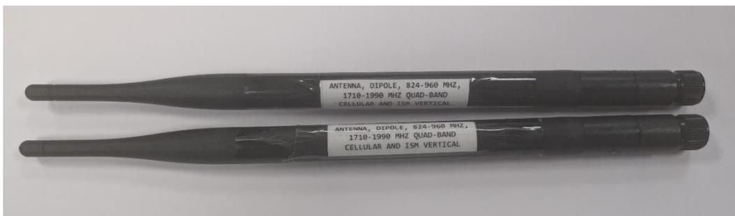
Figura 6: Antenas para la banda GSM 900
