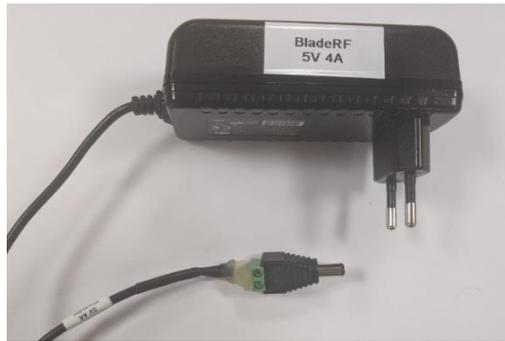
Figura 5: Alimentación modificada de la FPGA BladeRFx40
