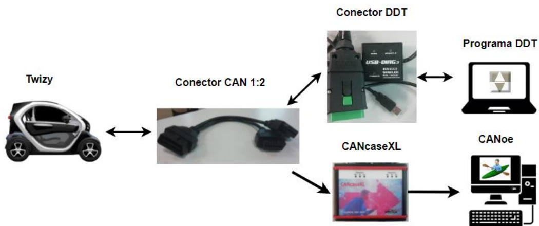
Figura 71. Esquema de trabajo utilizado en la primera fase de comprensión de los mensajes intercambiados.
