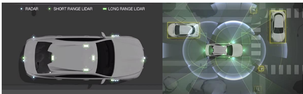
Figura 13. Posición de los sensores y alcance de ellos en el Lexus LS con el sistema Toyota Platform 3.0. [48]
