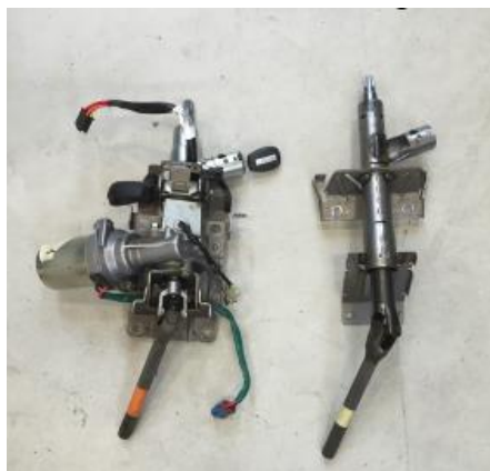
Figura 15. A la izquierda la columna de dirección de un Renault Clio2, y a la derecha la columna original del Renault Twizy del proyecto. [52]
