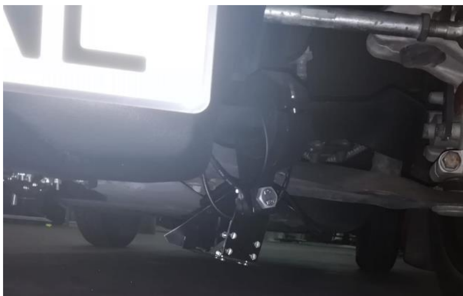
Figura 29. Sensor RFID sujetado al chasis a la derecha de la rueda izquierda.
