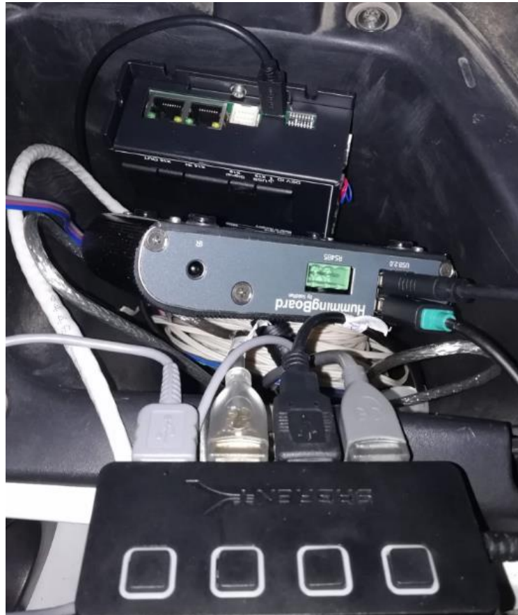
Figura 36. Zona derecha del salpicadero, donde se observa de arriba a abajo: controladora EPOS4-70/15, módulo de control y hub de conexión para los sensores.
