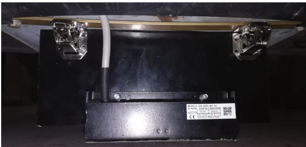
Figura 28. Sensor magnético situado abajo de la parte delantera del coche.
