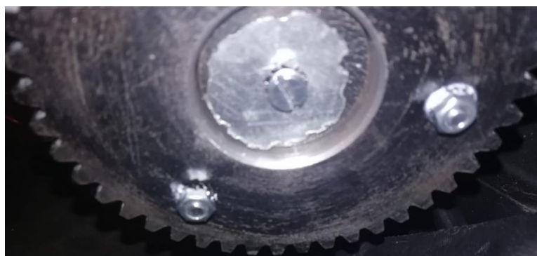
Figura 39. Platina redonda metálica que evita que se deslice hacia abajo el engranaje.
