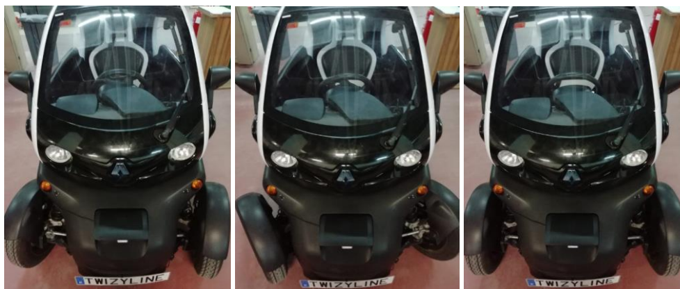
Figura 46. Secuencia de fotos ilustrando el modo homing. De izquierda a derecha: orientación de las ruedas tras dejar un usuario el Twizy en el punto de aparcamiento; orientación de las ruedas una vez a entrado el Twizy en modo autónomo y ha llegado al tope girando a la izquierda; orientación final de las ruedas centradas cuando termina el modo homing.
