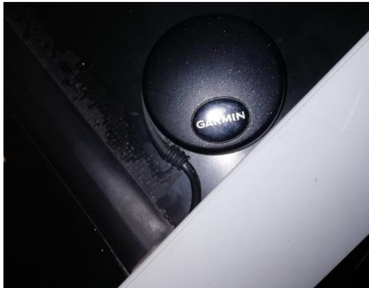
Figura 31. Receptor GPS Garmin colocado en el techo del coche, justo encima de la luna.
