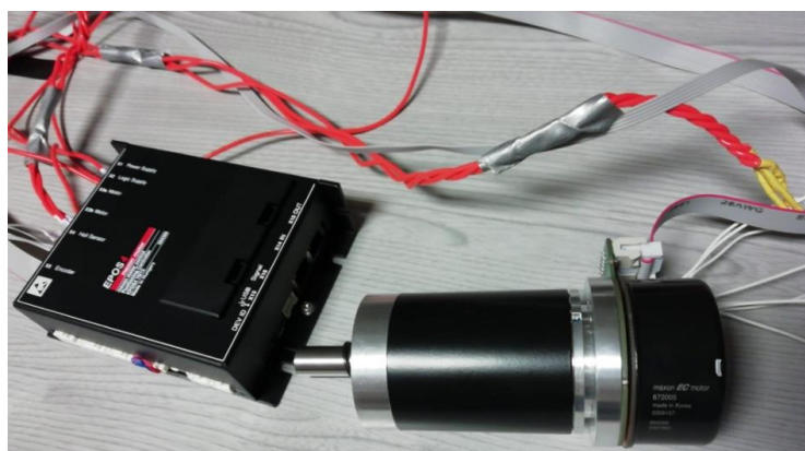
Figura 37. A la izquierda podemos ver la controladora EPOS4 y a la derecha el motor EC60 flat (brushless) junto el encoder MILE512 y la reductora planetaria GP52C.
