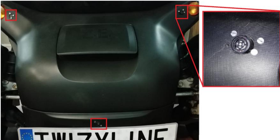
Figura 32. Sensores de ultrasonidos colocados en el morro delantero del vehículo.
