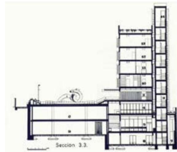
Fig. 5.10. Sección longitudinal del Colegio de Arquitectos.
