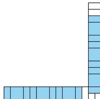
Ilustración 123: Encuentro en esquina de muro macizo de hiladas alternas. Axonometría y planta. Elaboración propia.
