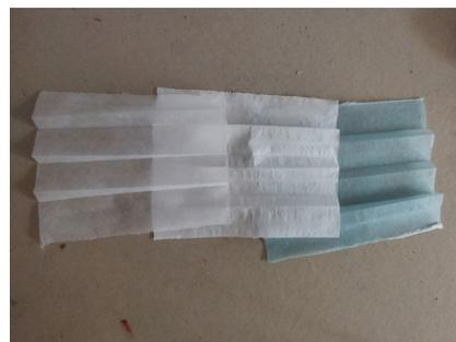
Ilustración 105: Mascarilla separada en sus 3 capas. Elaboración propia.
