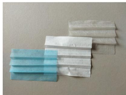
Ilustración 88: Capas que componen una mascarilla. Elaboración propia.
