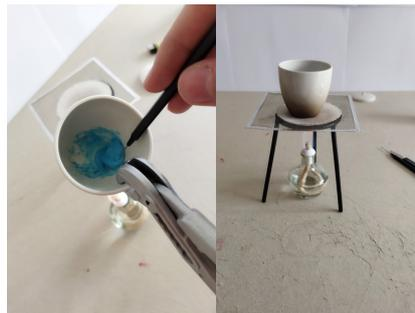
Ilustración 112: Proceso de fundición de las mascarillas mediante un mechero de alcohol. Elaboración propia.
