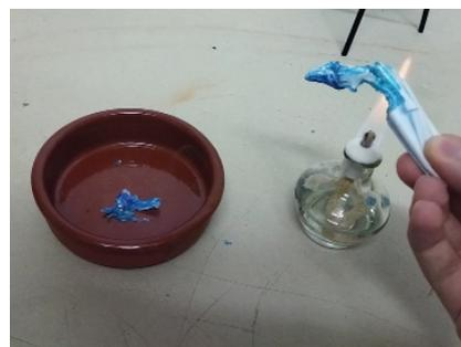
Ilustración 102: Mascarilla derretiéndose sobre la llama. Elaboración propia.
