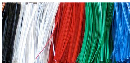
Ilustración 27: Tira de sujeción mascarillas quirúrgicas (Material para mascarillas y tejido no tejido sanitario, 2020)
