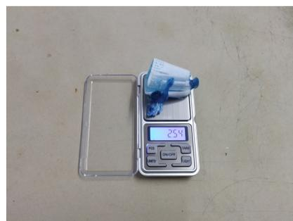
Ilustración 103: Peso de la mascarilla después del ensayo, 2,54g. Elaboración propia.
