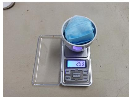
Ilustración 100: Peso de la mascarilla antes del ensayo, 2,58g. Elaboración propia.
