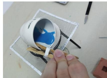
Ilustración 110: Vertido del polipropileno fundido en el molde de arcilla. Elaboración propia.
