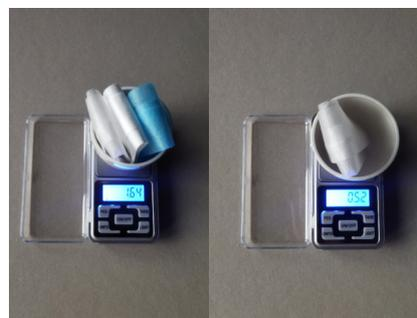
Ilustración 78: Peso de las tres capas: 1,64g. Peso de la capa interior: 0,52g. Elaboración propia.
