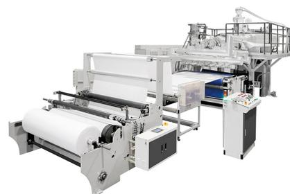
Ilustración 24: Maquinaria de extrusión industrial para tejido no tejido meltblown. (Material para mascarillas y tejido no tejido sanitario, 2020)
