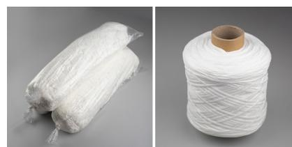
Ilustración 26: Gomas elásticas para mascarillas quirúrgicas (izquierda) y FFP2 (derecha). (Material para mascarillas y tejido no tejido sanitario, 2020)
