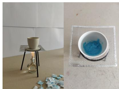
Ilustración 106: Proceso de fundición de la mascarilla en un crisol cerámico. Elaboración propia.
