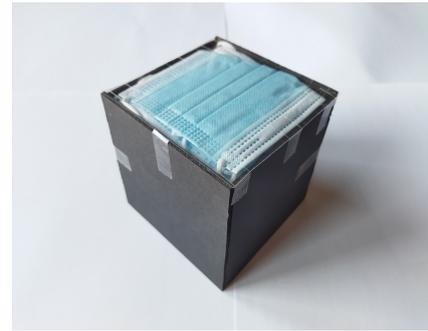
Ilustración 120: Cubo de 10cm de lado lleno de mascarillas recicladas. Elaboración propia.
