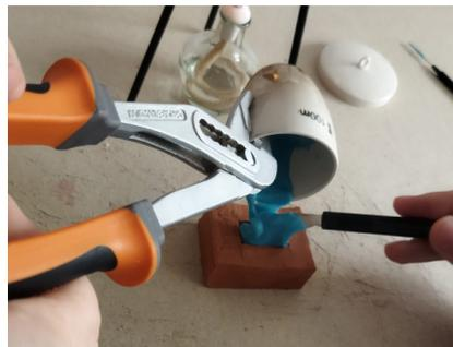
Ilustración 113: Vertido del polipropileno en el molde de arcilla. Elaboración propia.
