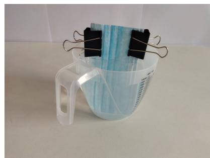
Ilustración 86: Mascarilla semisumergida en agua destilada. Elaboración propia.
