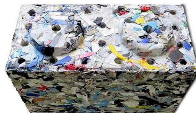
Ilustración 55: Bloque de plástico reciclado ByBlock (Powell, 2020)
