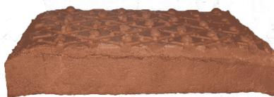
Ilustración 45: Adoquín plástico de resistencia moderada. (Gjenge Makers, 2020)
