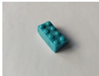
Ilustración 116: Ladrillo de LEGO hecho con mascarillas quirúrgicas fundidas. Elaboración propia.
