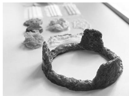
Ilustración 70: Base del taburete de polipropileno fundido. (Slatter, 2021)
