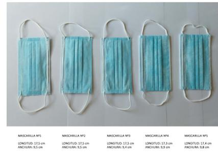
Ilustración 72: Mascarillas sin modificar, dimensiones. Elaboración propia.
