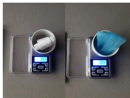
Ilustración 79: Peso de la capa intermedia: 0,57g. Peso de la capa exterior: 0,54g. Elaboración propia.
