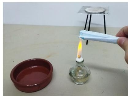
Ilustración 101: Mascarilla quirúrgica en contacto con la llama de un mechero de alcohol. Elaboración propia.
