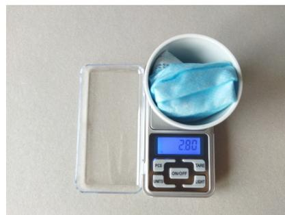
Ilustración 80: Peso de la mascarilla previo al ensayo, 2,80g. Elaboración propia.
