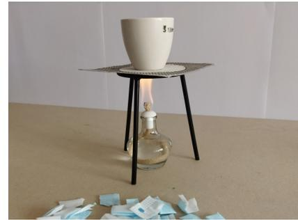
Ilustración 108: Proceso de fundición de las mascarillas mediante un mechero de alcohol. Elaboración propia.
